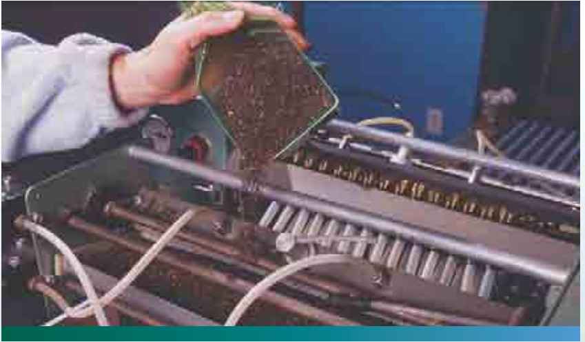
Alimentation d'une machine d'ensemencement
